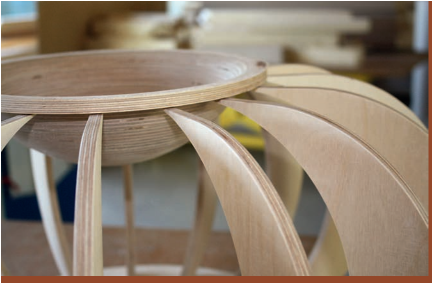
«The modern Birdnest» – eine Steckkonstruktion aus Sperrholz
