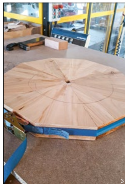
1 3D-Scannen 2 Fräsen 3 Rohling-Herstellung
