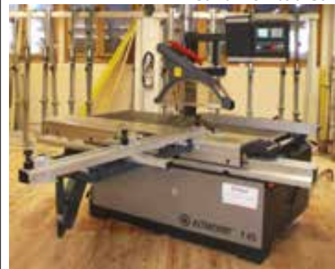
Formatkreissäge Altendorf F-45 mit beidseitiger Schwenkung Freund Holzbau Samedan
